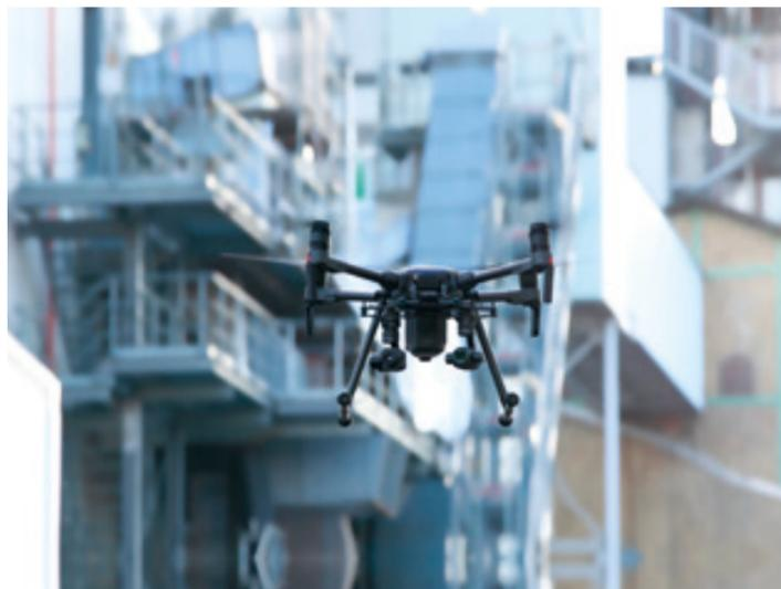
Industriedrohne mit Wärmebildkamera zur Identifizierung von Wärmelecks.
