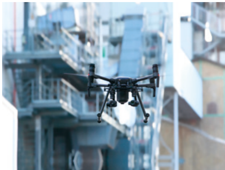
Industriedrohne mit Wärmebildkamera zur Identifizierung von Wärmelecks.
